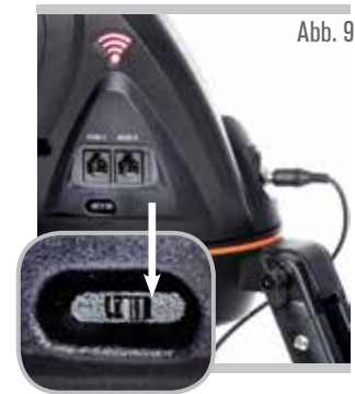
WiFi-Schalter auf rechts position
