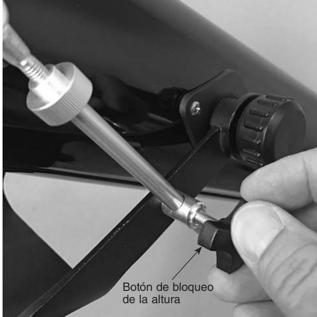
Figura 9. Enrosque el botón de bloqueo de la altura.
