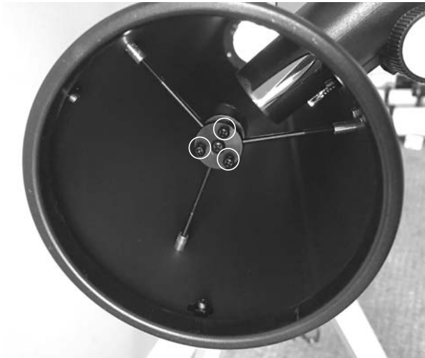
Figura 15. Ajuste la inclinación del espejo secundario ajustando los tres tornillos de alineación con un destornillador de estrella.
