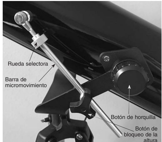
Figura 13. La rueda selectora y la barra de micromovimiento permiten un control de apuntado preciso de la altura.
