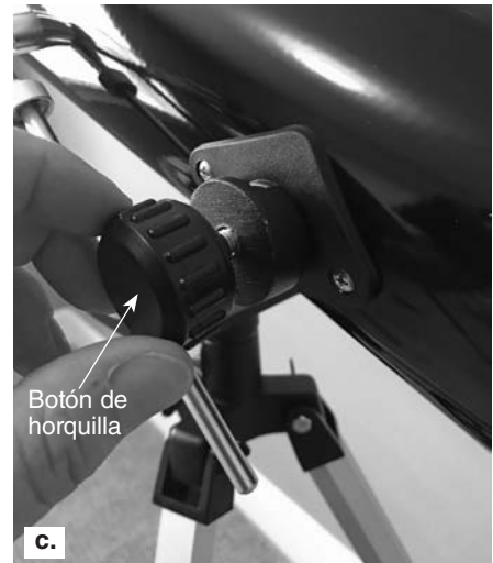
Figura 8. Instalación del tubo óptico en la montura. a) Deslice la barra de micromovimiento en el receptáculo metálico. b) Coloque las piezas de altura en el tubo óptico en las ranuras de la horquilla. c) Monte los botones de la horquilla.
