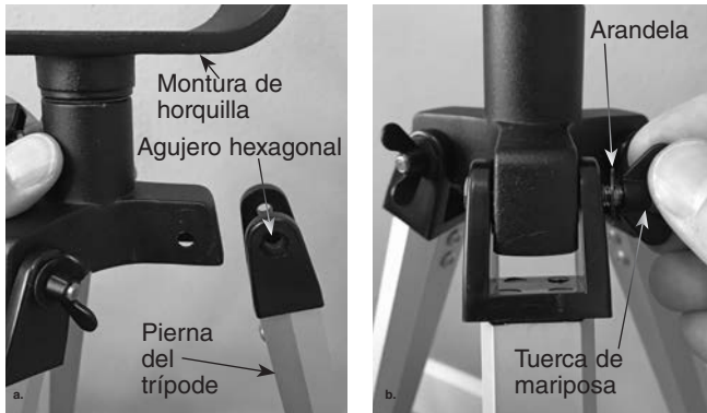
Figura 5. a) Acople las tres patas del trípode a la montura de horquilla, asegurándose de que la cabeza hexagonal del perno se apoya sobre el hueco hexagonal de la pata del trípode. b) Coloque una arandela y una tuerca de mariposa sobre el extremo expuesto del perno.
