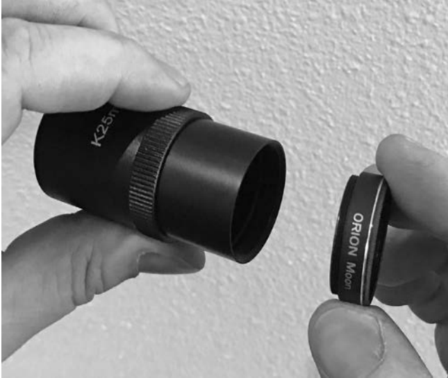
Figura 18. Los oculares Kellner tienen cilindros roscados que admiten filtros opcionales de 31,75 mm de Orion. Un filtro lunar es útil para reducir el resplandor y ver más detalles de la superficie lunar.
