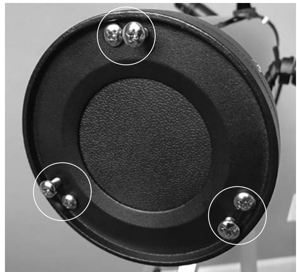
Figura 24. Alinee el espejo primario ajustando los tres pares de tornillos de "empujar y tirar" del extremo posterior del tubo óptico..
