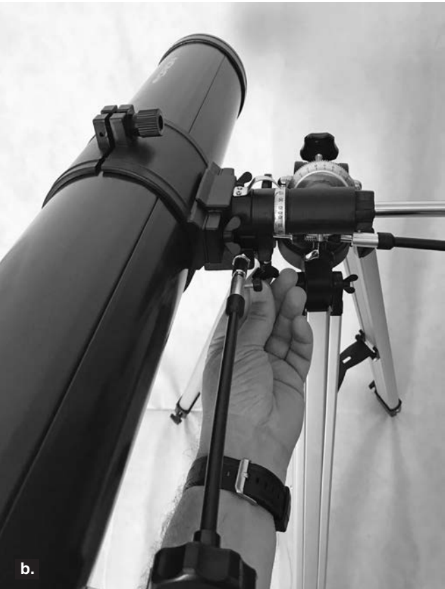
Figura 20. Equilibrado del telescopio respecto a) los ejes de ascensión recta y b) declinación.
