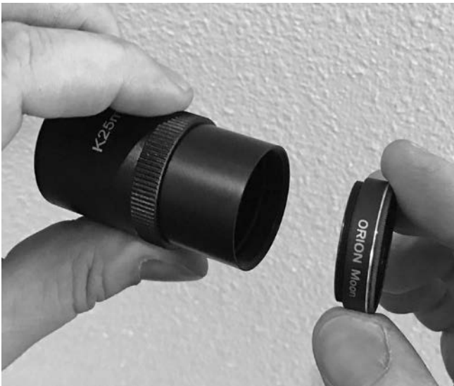
Figura 26. Los oculares Kellner tienen cilindros roscados que admiten filtros opcionales de 31,75 mm de Orion. Un filtro lunar es útil para reducir el resplandor y ver más detalles de la superficie lunar.
