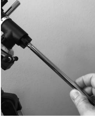
Figura 9. Enrosque el eje de contrapeso en la carcasa de declinación.
