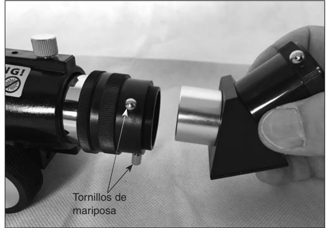
Figura 10. Inserte la diagonal de imagen correcta de 45 grados en el tubo del enfocador y sujétela con los dos tornillos de mariposa.
