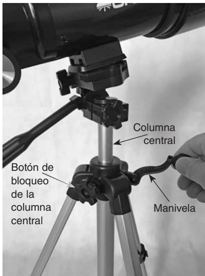
Figura 13. Utilice la manivela para subir o bajar la columna central engranada, pero no olvide aflojar antes un poco el botón de bloqueo de la columna central.
