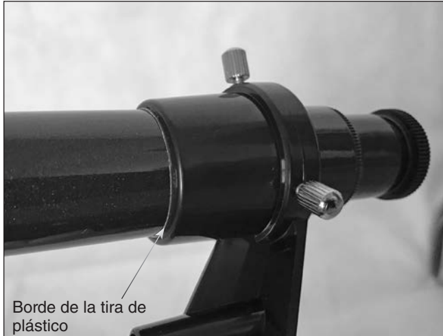
Figura 8. Deslice primero el extremo del ocular del tubo del telescopio buscador, a través del soporte, asegurándose de que la tira de plástico rodea el tubo. La tira apenas debe ser visible cuando el telescopio buscador esté completamente insertado, tal como se indica.
