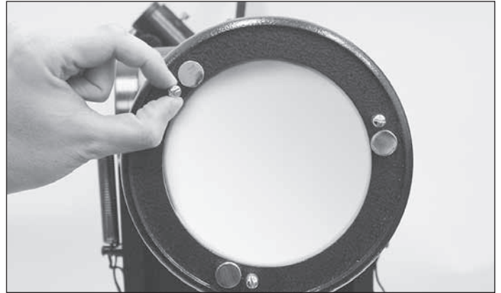
Figura 16. Los tres tornillos de mariposa pequeños que bloquean el espejo primario en su lugar se deben aflojar antes de realizar cualquier ajuste.
