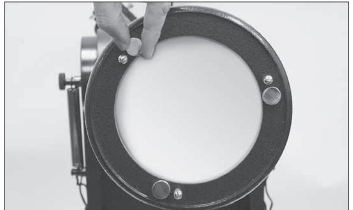
Figura 17. La inclinación del espejo primario se ajusta girando uno o varios de los tres tornillos de mariposa de mayor tamaño.
