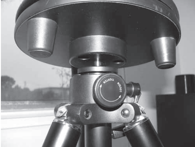
Figura 10: Montaje de la base de mesa en un trípode fotográfico
