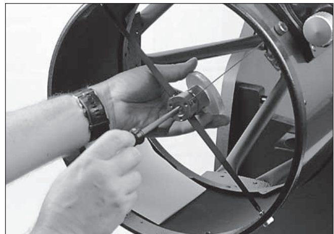
Figura 30. Para centrar el espejo secundario bajo el enfocador, sostenga el soporte del espejo en su lugar con una mano mientras ajusta el perno central con un destornillador de estrella. No toque la superficie del espejo.
