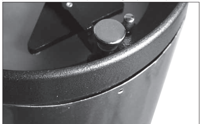
Figura 17. Localice el área del tubo que sobresale hacia fuera y evita que el anillo del extremo encaje completamente. Presione sobre esta protuberancia para permitir que la celda del espejo encaje adecuadamente en el tubo. ¡Tenga cuidado de no pillarse los dedos!
