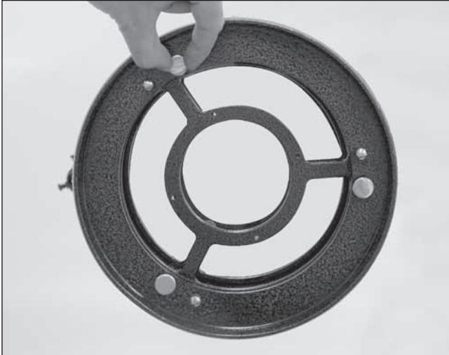
**Figura 23.** Los tres tornillos de mariposa pequeños que bloquean el espejo primario en su lugar se deben aflojar antes de realizar cualquier ajuste. A continuación, se puede ajustar la inclinación del espejo primario girando uno o varios de los tres tornillos de mariposa de mayor tamaño.
