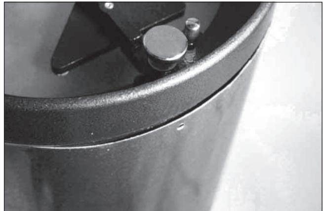
**Figura 1.7.** Localice el área del tubo que sobresale e impide que la celda del espejo encaje completamente.
